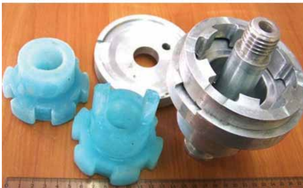
Рис. 3. Пресс-формы для получения ледяных моделей
