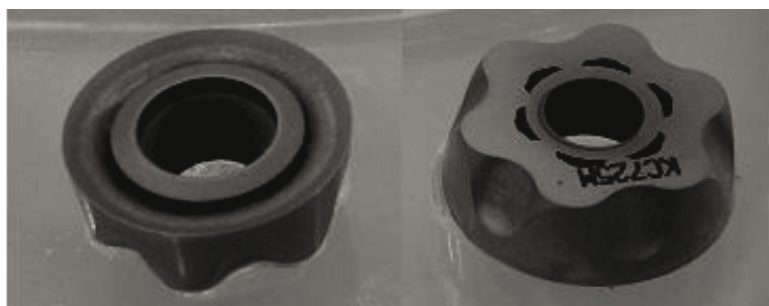
Рис. 10. Пластина для фрезерования производства ООО «KENNAMETAL» с каналами для подвода СОТС
