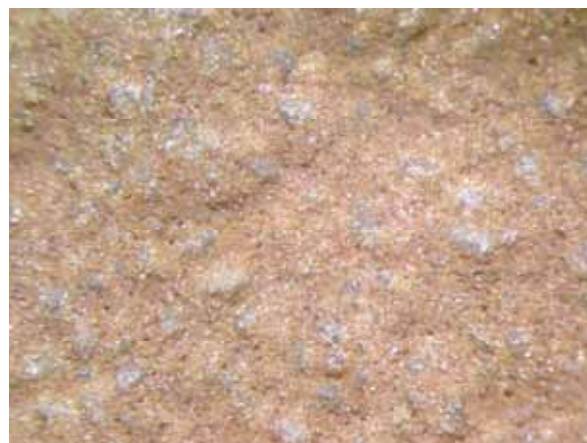
Рис. 1. Структура оболочковых форм: а – форма, полученная по традиционной технологии; б – форма, полученная электрофорезом
