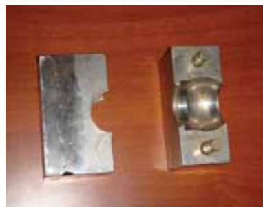
Рис. 4. Технологическая оснастка для деформирования заготовок льдом: а – листовых; б – трубчатых
