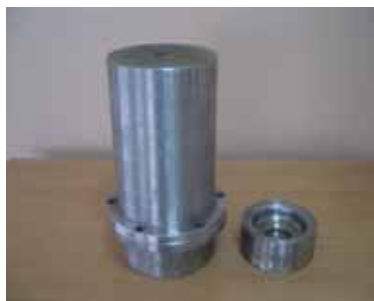
Рис. 4. Технологическая оснастка для деформирования заготовок льдом: а – листовых; б – трубчатых
