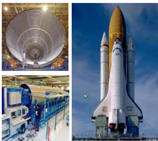
Рис. 7. Закрепление панелей в установке для СТП продольных швов цилиндра бака ракеты «Дельта II – IV»
