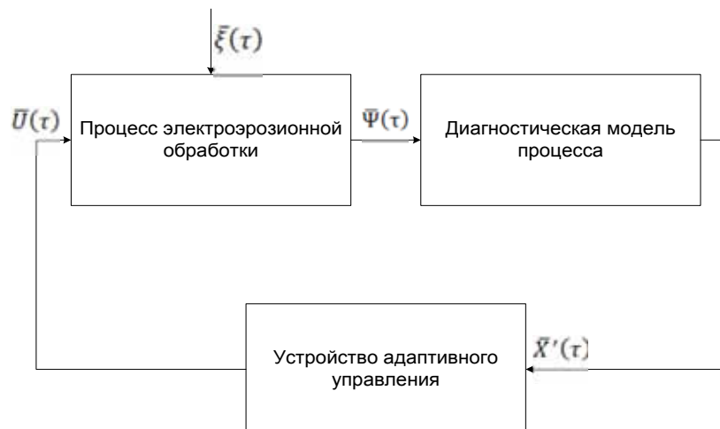
Рис. 1. Структурная схема построения адаптивного управления процессом электроэрозионной обработки: \bar{U}(\tau) – вектор управления; \bar{\xi}(\tau) – вектор возмущающих воздействий; \bar{X}'(\tau) – вектор предполагаемых значений выходных параметров процесса; \bar{\Psi}(\tau) – вектор физически измеримой информации в процессе
