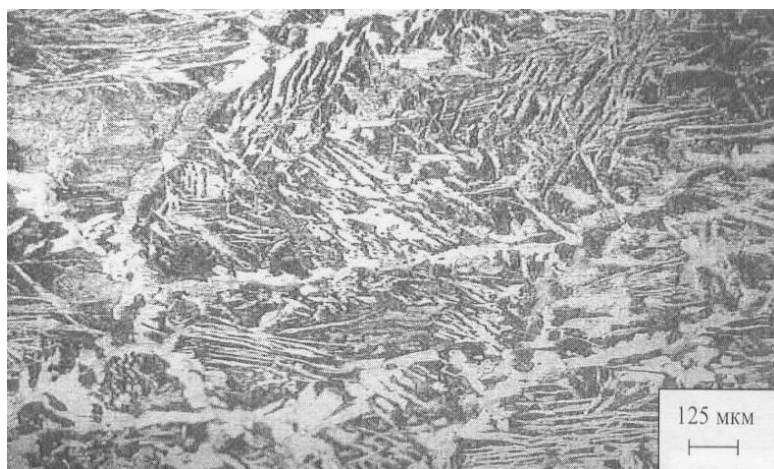
Рис. 1. Явно выраженная видманштеттова структура в тест-образце
