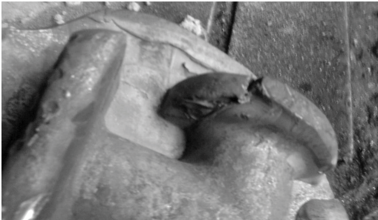
Рис. 6. Дефекты на поверхности штамповки корпуса АТЭК.731736.020
