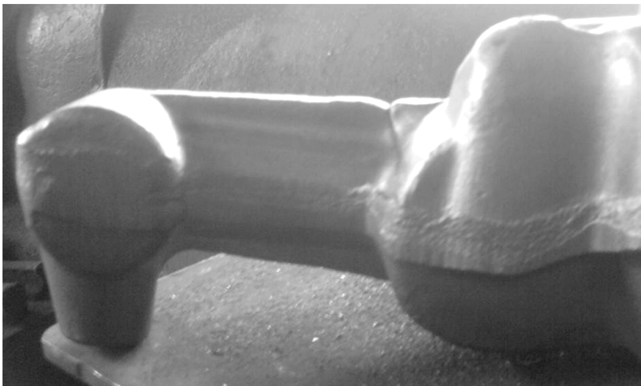
Рис. 5. Фотография тыльной стороны изготовленной заготовки корпуса Д7.8710-1721 с дефектом
