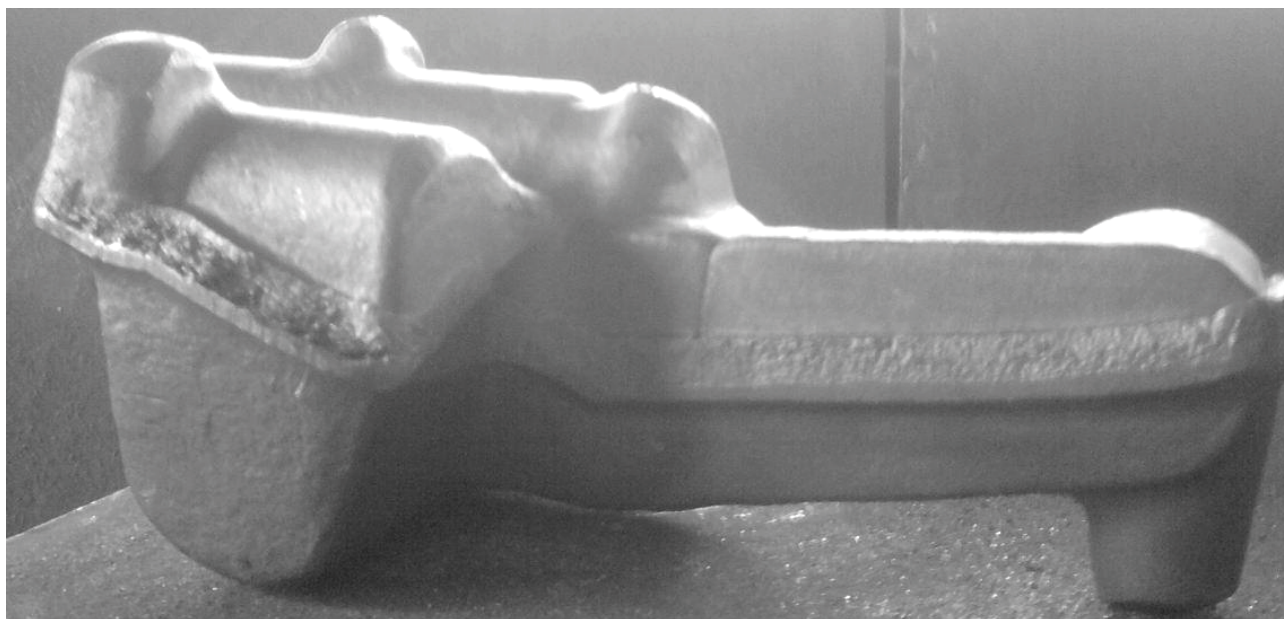
Рис. 4. Фотография лицевой стороны изготовленной заготовки корпуса Д7.8710-1721 с дефектом
