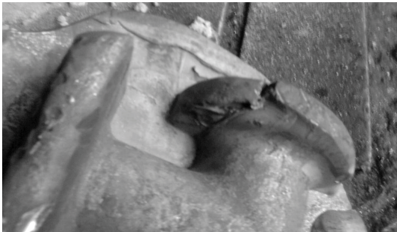
Рис. 6. Дефекты на поверхности штамповки корпуса АТЭК.731736.020
