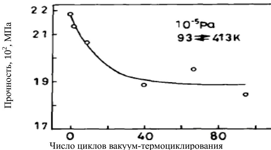
Рис. 5. Изменение прочности образцов из М40J/5228А на разрыв при вакуум-термоциклировании
