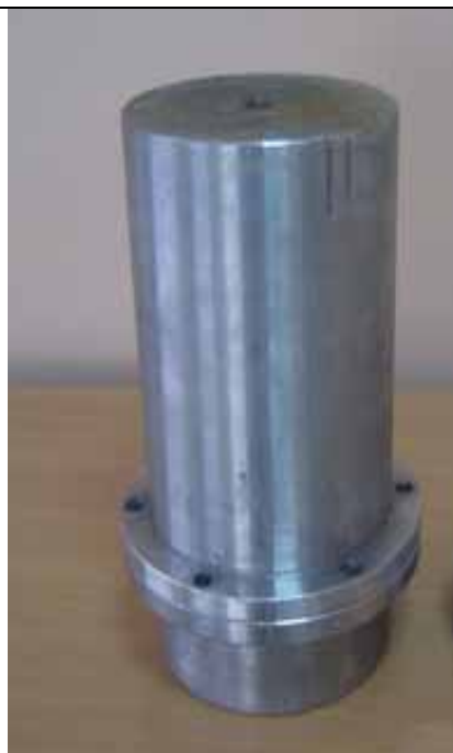
Рис. 2. Технологическая оснастка для деформирования льдом листовых заготовок
