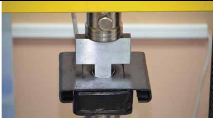
Рис.4. Гибка листовой заготовки в штампе
