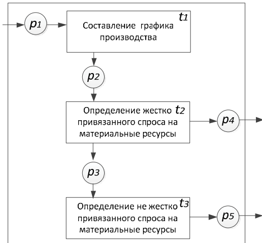
Рис. 6. Фрагмент сети Петри, моделирующий процессы, происходящие в АСУП при формировании управляющих воздействий
