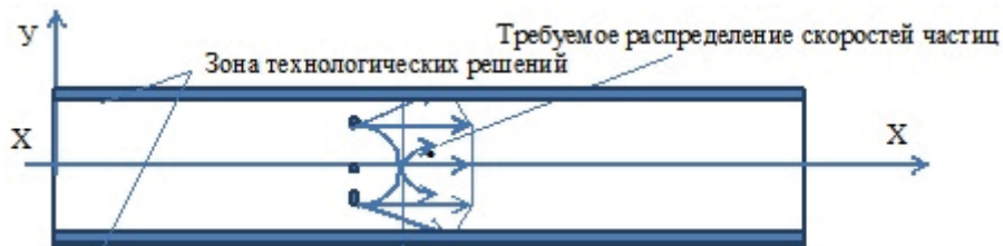
Рис. 4. Требуемый профиль скоростей
