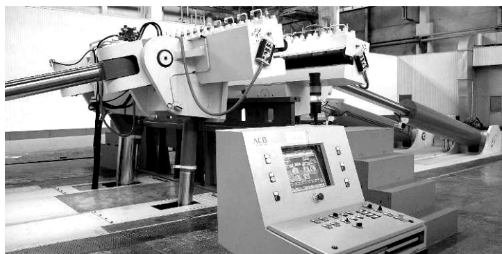
Рис. 2. Обтяжной пресс FET-1500
