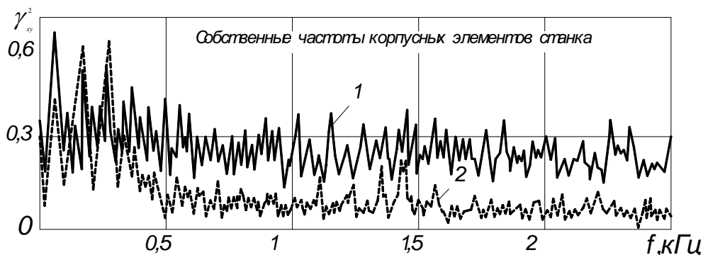
Рис. 8. Функции когерентности виброускорений вертикально-сверлильного станка мод. 2Н135
