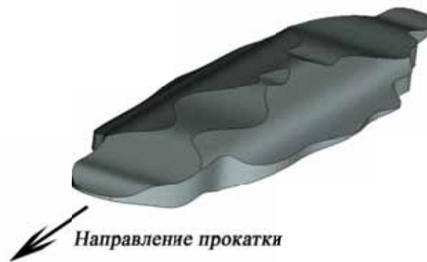
Рис. 7. Объемная модель графитного включения, подвергнутого деформации
