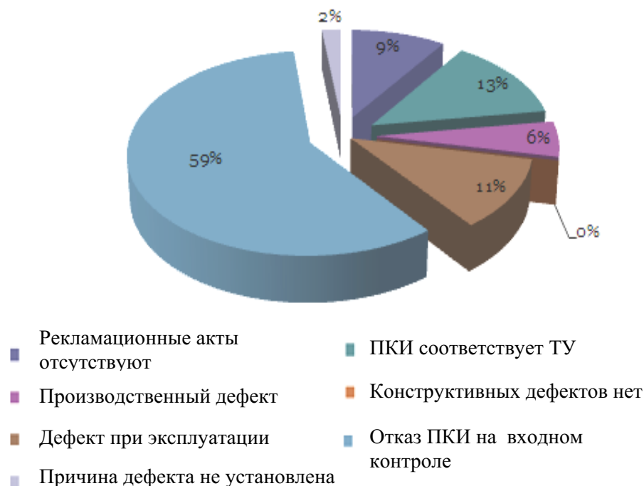
Рис. 5. Виды дефектов, встречающихся в ПКИ бортовой комплексной системы
