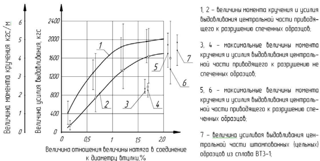
Рис. 5. Влияние диффузионного спекания на прочностные свойства прессового соединения холоднопрессованной заготовки из сплава 2М2А и листовой заготовки из сплава ВТ20
