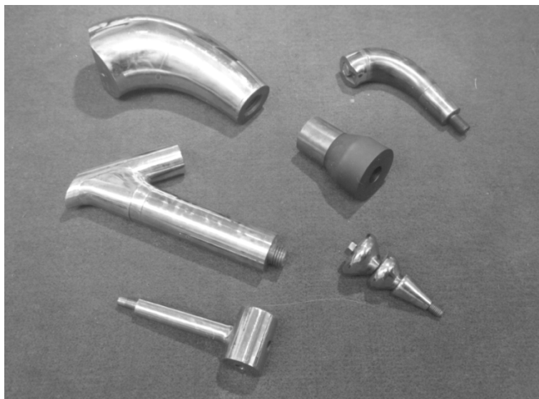
Рис. 4. Технологическая оснастка для изготовления монтажных заготовок
