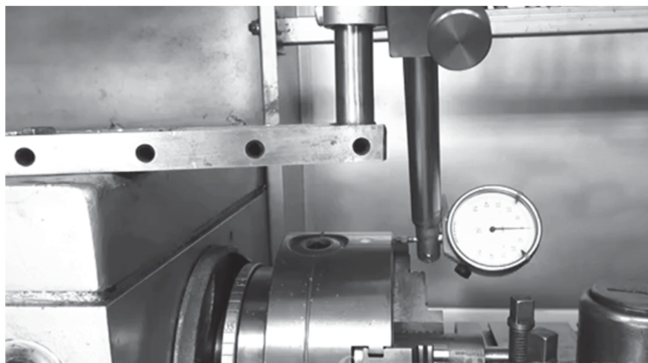
Рис. 1. Индикаторная стойка для измерения осевого зазора
