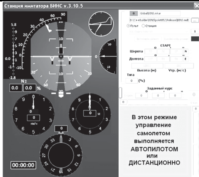
Рис. 3. Интерфейс имитатора БИНС в режиме управления станцией от ручного (внешнего) пульта:
