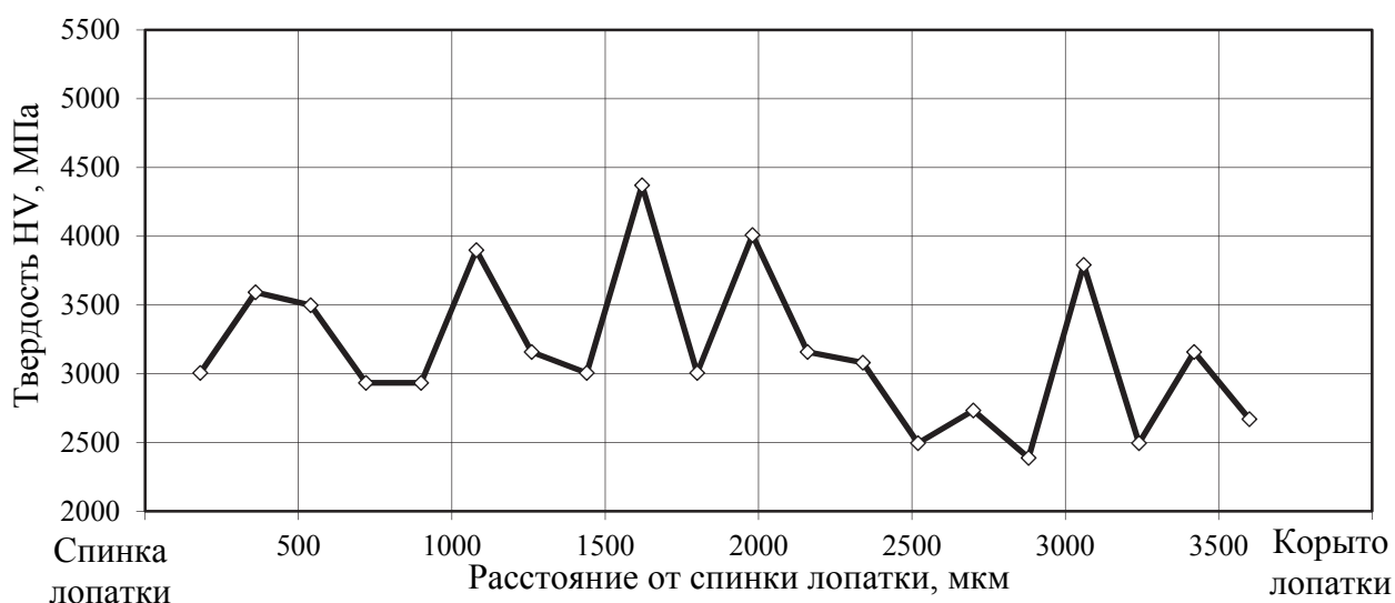
Рис. 7. Микротвердость сплава TNM-B1 по сечению литой лопатки (образец № 3)
