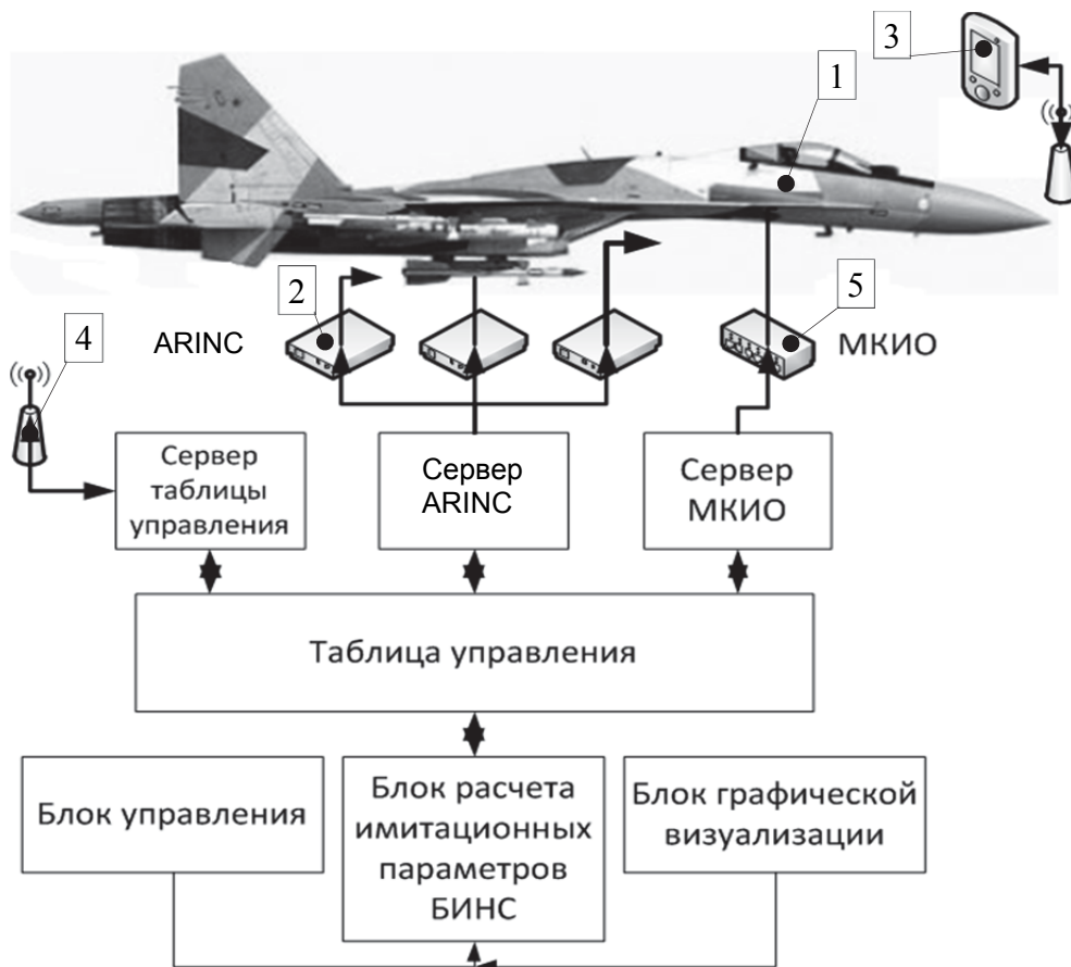
Рис. 2. Схема функционирования ПК имитации БИНС
