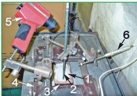
Рис. 1. Лабораторные установки: а – установка для исследования влияния дуговых разрядов на МС: 1 – переплавляемый материал, 2 – вольфрамовый электрод, 3 – кристаллизатор, 4 – каретка, 5 – пирометр, 6 – газоанализатор; б – установка электрошлакового переплава
