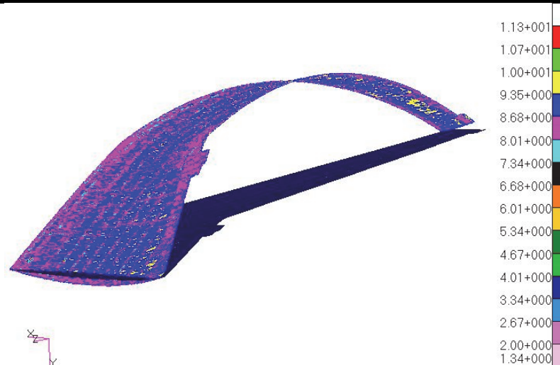
Рис. 4. Распределение эффективного напряжения в заготовке на рабочей поверхности штамповой оснастки для материала по (2)
