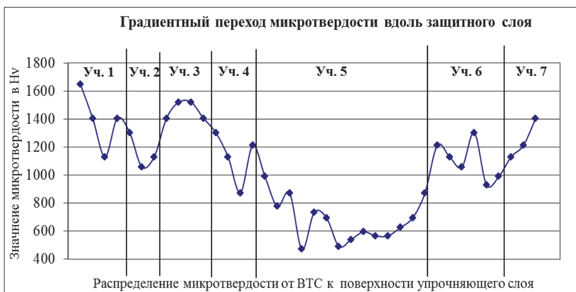
Рис. 6. Распределение микротвердости защитного слоя
