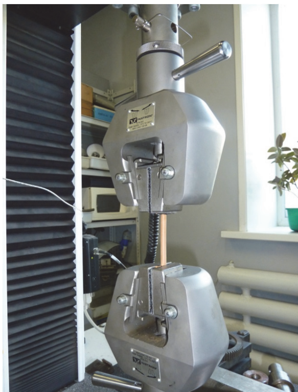
Рис. 1. Испытание на одноосное растяжение
