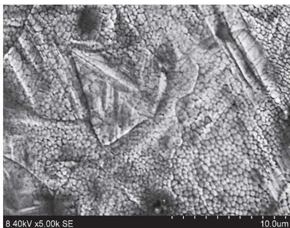
Рис. 4. Поверхность после лазерной обработки и твердофазных структурных превращений: а – железо-армко; б – быстрорежущая сталь
