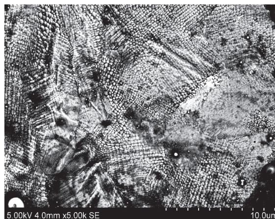
Рис. 4. Поверхность после лазерной обработки и твердофазных структурных превращений: а – железо-армко; б – быстрорежущая сталь
