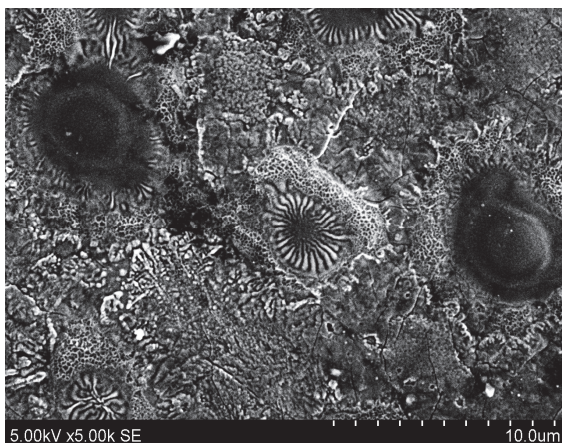
Рис. 1. Поверхности железа-армко (а) и быстрорежущей стали Р6М6К5 (б) на пятне лазерного воздействия, сформированные из оплавленного слоя с турбулентными массовыми потоками
