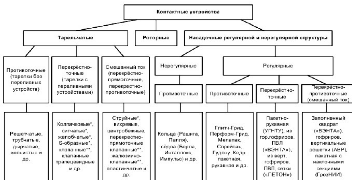
Рис. 1. Общая классификация контактных устройств
