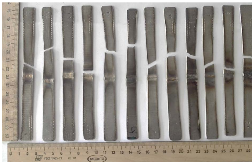
Рис. 3. Внешний вид плоских образцов после проведения испытаний на статическое растяжение
