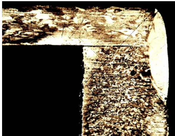
Рис. 6. Лазерная сварка 29НХ: коэффициент формы шва \varphi_{пр} = 3,63
