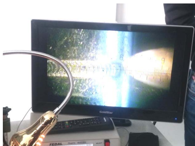
Рис. 3. Телевизионная система наблюдения зоны сварки
