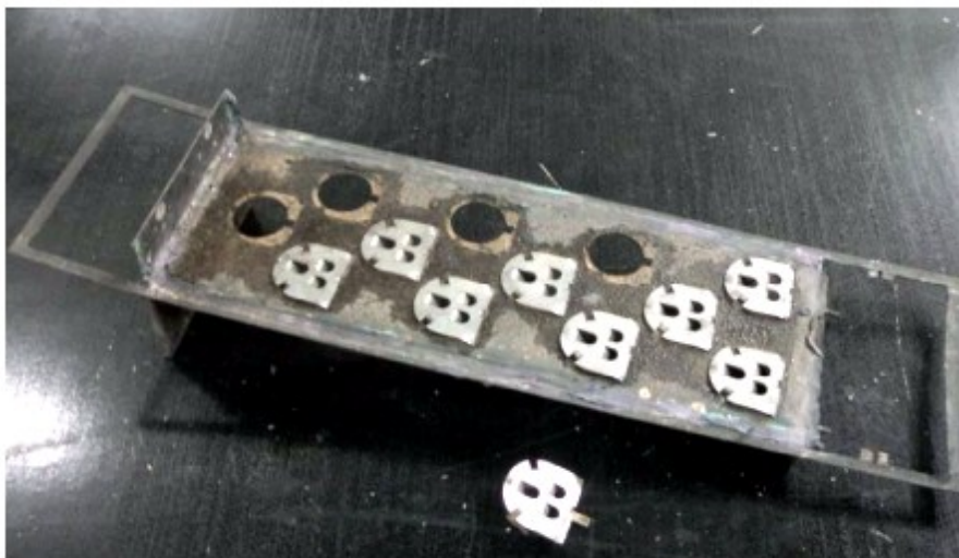
Рис. 1. Прямоточная клапанно-ситчатая тарелка новой конструкции
