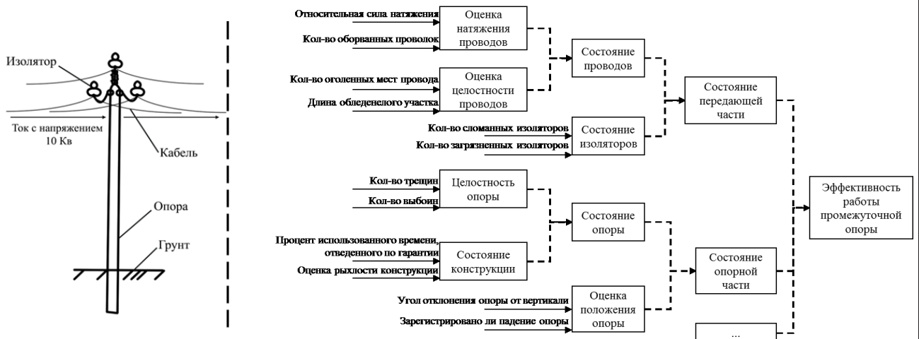
Рис. 6. Структура виртуального блока
