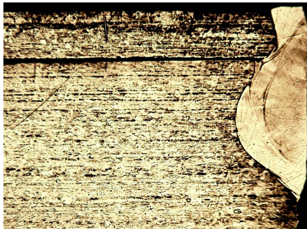
Рис. 7. Лазерная сварка 29НХ: коэффициент формы шва \varphi_{пр} = 2,75
