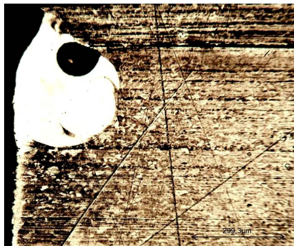
Рис. 8. Дефекты сварного шва
