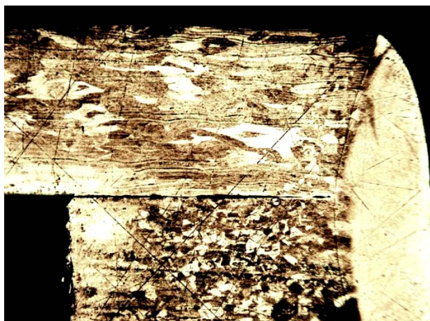
Рис. 5. Микроструктура сварного соединения из сплава 29НК
