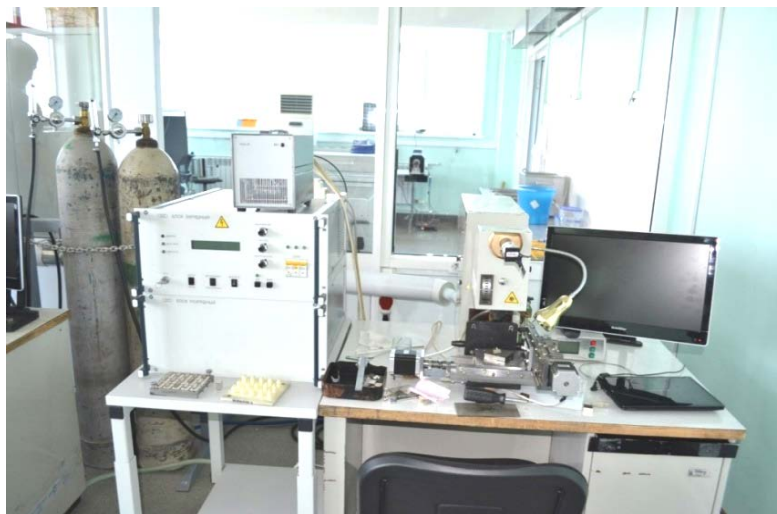
Рис. 2. Установка для лазерной сварки «Квант-15 МСЗ»
