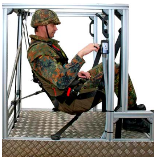
Рис. 6. Подвесная система крепления сидения (ноги находятся на платформе)
