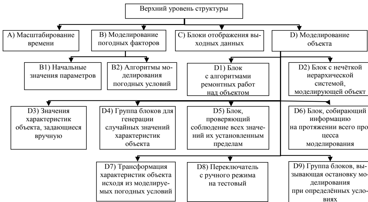
Рис. 8. Структура фрагмента имитационной модели
