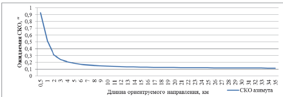
Рис. 3. Ожидаемые СКО определения геодезических азимутов в зависимости от расстояния D между точками установки антенн АП КНС, приведенного на плоскость горизонта
