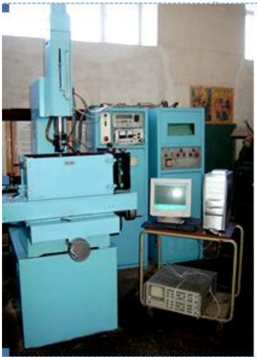
Рис. 3. Копировально-прошивочный электродный станок (а) и схема экспериментальной установки (б): 1 – электрод-инструмент; 2 – электрод-заготовка; 3 – рабочая жидкость; 4 – генератор; 5 – канал заряда; 6 – лунка, образованная разрядом; 7 – газовый пузырь; 8 – частицы металла (шлам); 9 – продукты пиролиза
