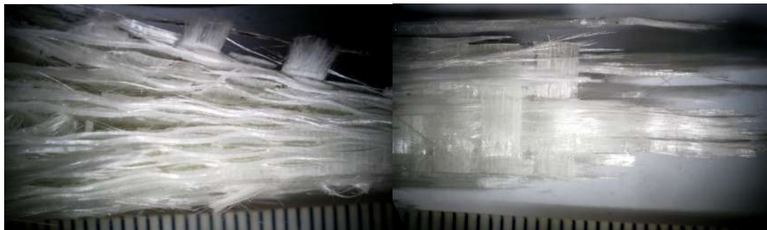
Рис. 4. Микрофотография разрушенных образцов стеклотекстолита. Указанный масштаб соответствует 1000 мкм
