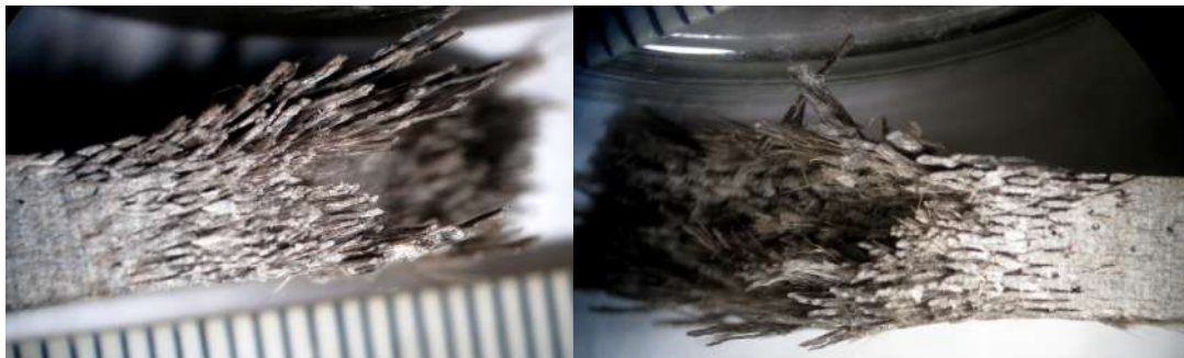
Рис. 3. Микрофотография разрушенных образцов базальтотекстолита. Указанный масштаб соответствует 1000 мкм
