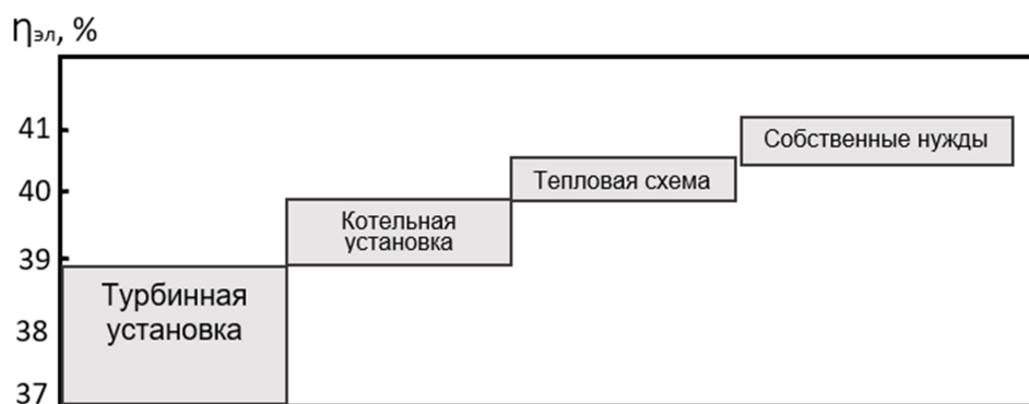
Рис. 2. Влияние совершенствования оборудования ТЭС на КПД энергоблоков
