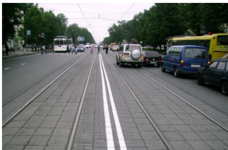
Рис. 5. Дорожная разметка с учётом трамвайных путей
