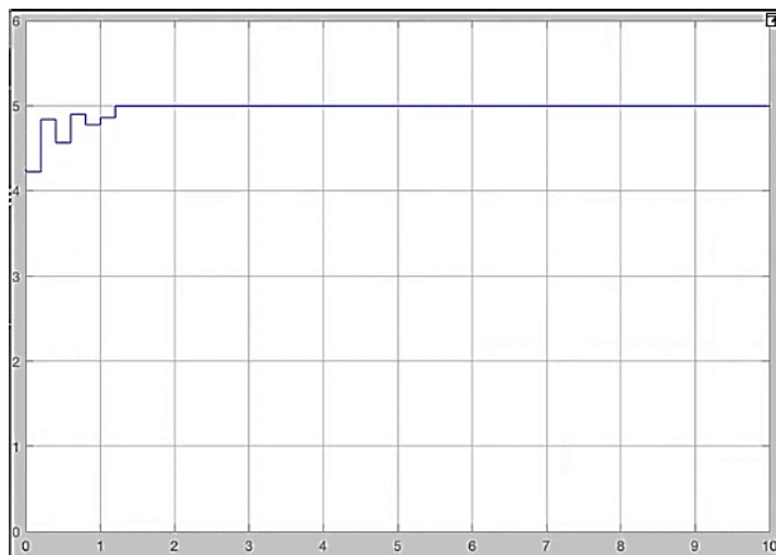
Рис. 4. Скачок напряжения на ёмкости при её уменьшении
