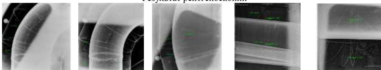
Рис. 7. Схемы процесса и результаты рентгеноскопии технологических трубопроводов
