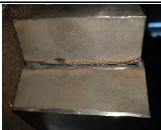
Рис. 9. Дефект в виде трещины вдоль всего корня шва
