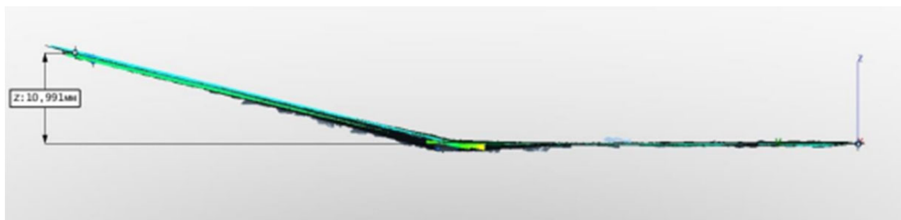
Рис. 3. Скан-модель в профиль с замером угловой деформации в 10,991 мм
