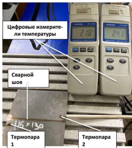
Рис. 2. Комплекс оборудования для исследований деформации и измерения температуры листовых деталей при выполнении стыковых сварных соединений лазерной сваркой
