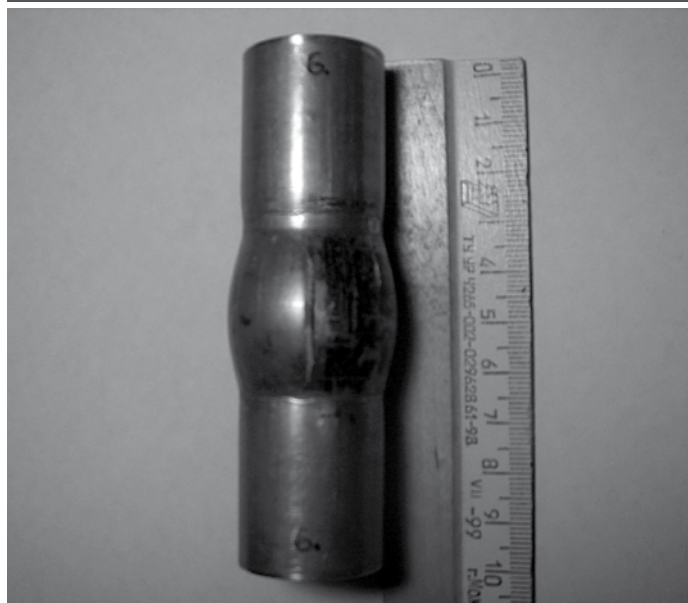
Рис. 17. Разрыв заготовки в опыте № 6
