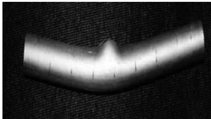
Рис. 3. Деформации заготовки с использованием наполнителя в виде воды
