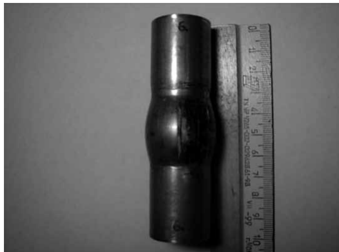
Рис. 12. Деформация заготовки при отсутствии шайб
