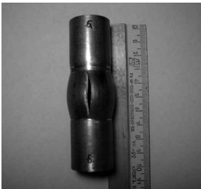
Рис. 16. Разрыв заготовки в опыте № 8
