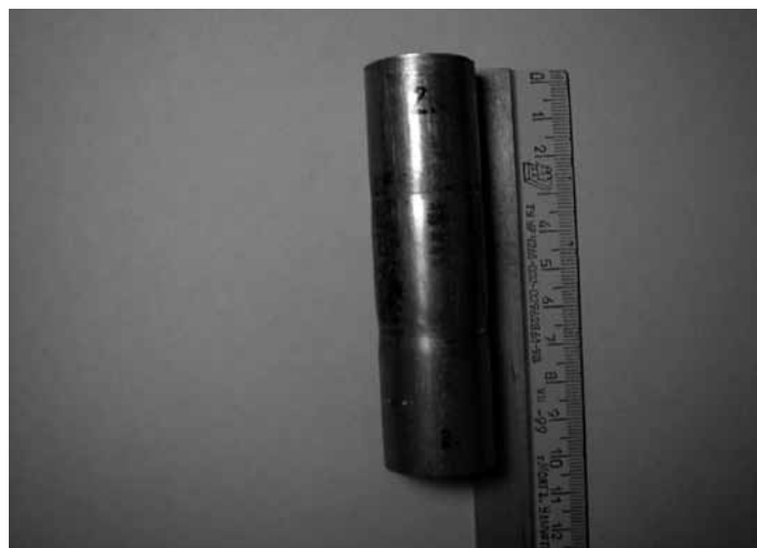
Рис. 13. Вид заготовки после установки шайб
