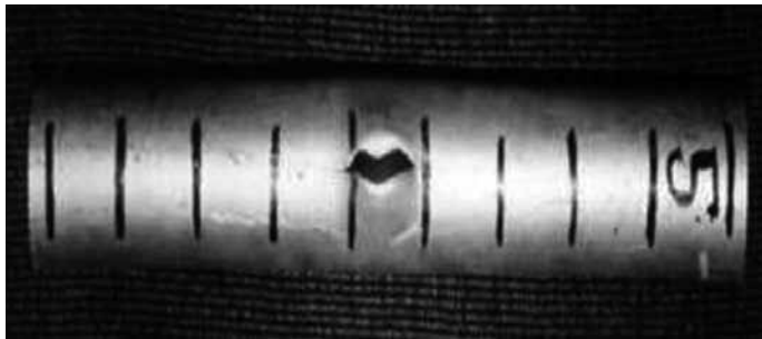
Рис. 5. Разрушение заготовки при проведении серии экспериментов №4
