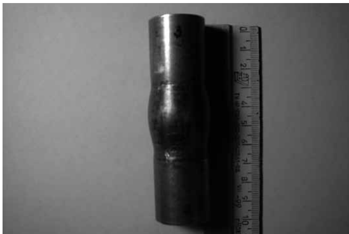
Рис. 14. Деформация заготовки без повреждений
