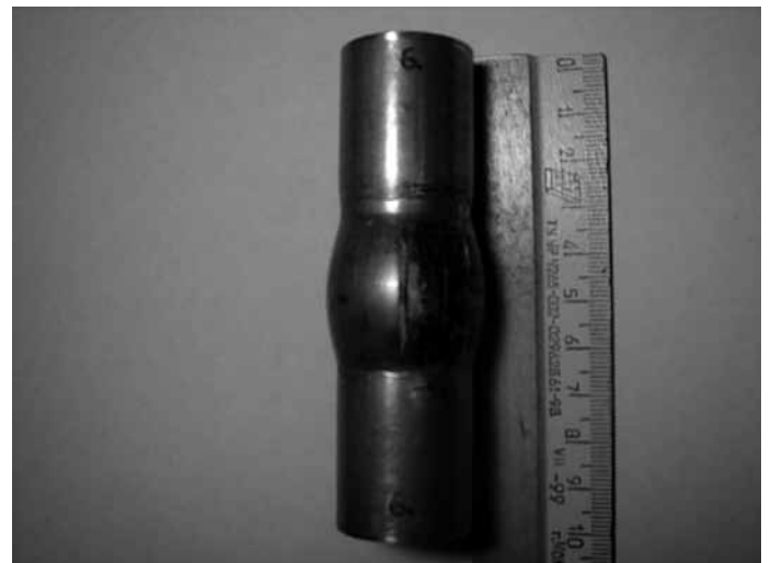
Рис. 12. Деформация заготовки при отсутствии шайб
