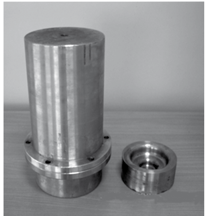
Рис. 22. Технологическая оснастка для деформирования листовых заготовок льдом
