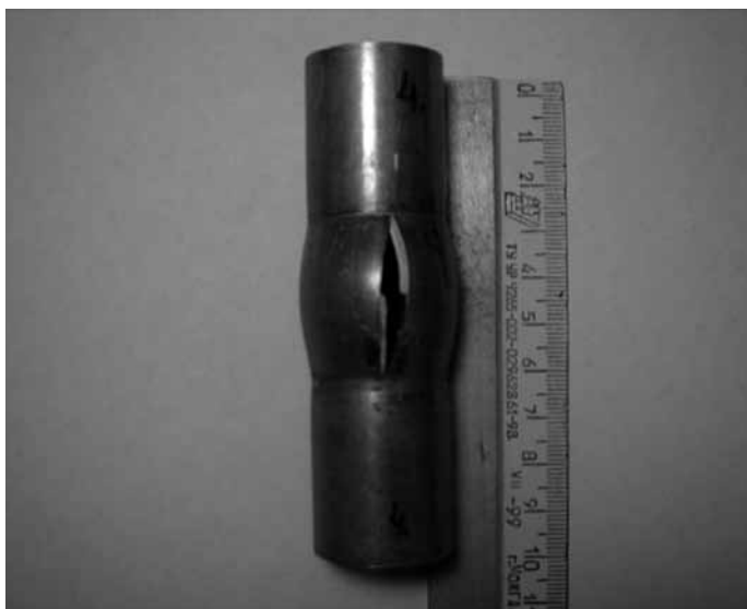
Рис. 15. Разрыв заготовки в опыте № 5
