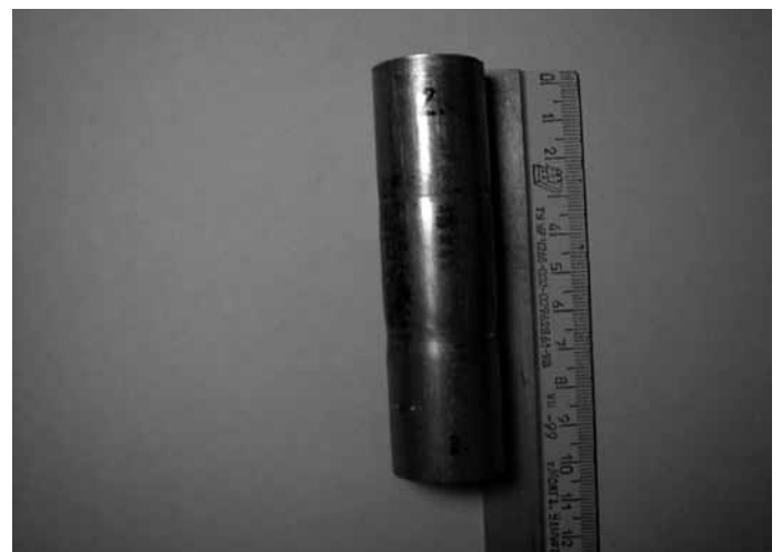
Рис. 13. Вид заготовки после установки шайб
