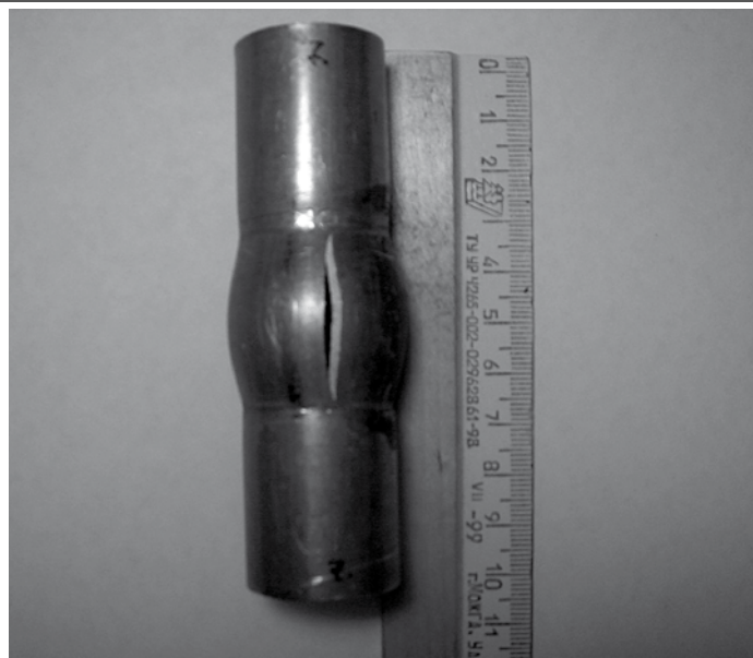
Рис. 18. Разрыв заготовки в опыте № 7.2
