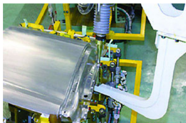
Рис. 10. Схема точечной сварки трением, используемая фирмой MAZDA, и устройство для ее выполнения
