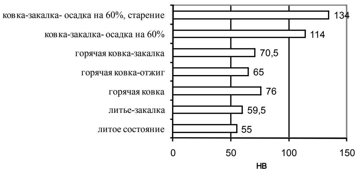
Рис. 7. Зависимость твердости высокохромовой бронзы от вида термомеханической обработки
