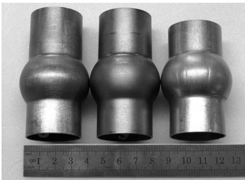
Рис. 6. Детали, изготовленные из сплавов: а – сталь 12Х18Н10Т; б – титан ОТ-4; в – алюминиевый сплав АМГ6М
