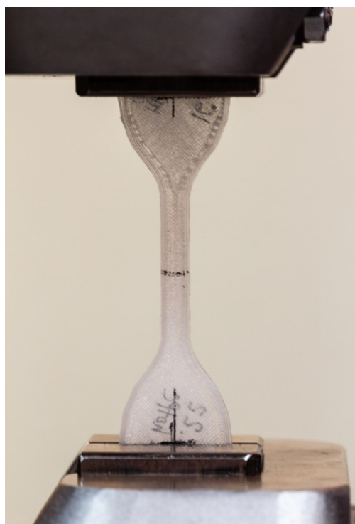
Рис. 1. Закрепление поликарбонатного образца в эксперименте на простое растяжение
