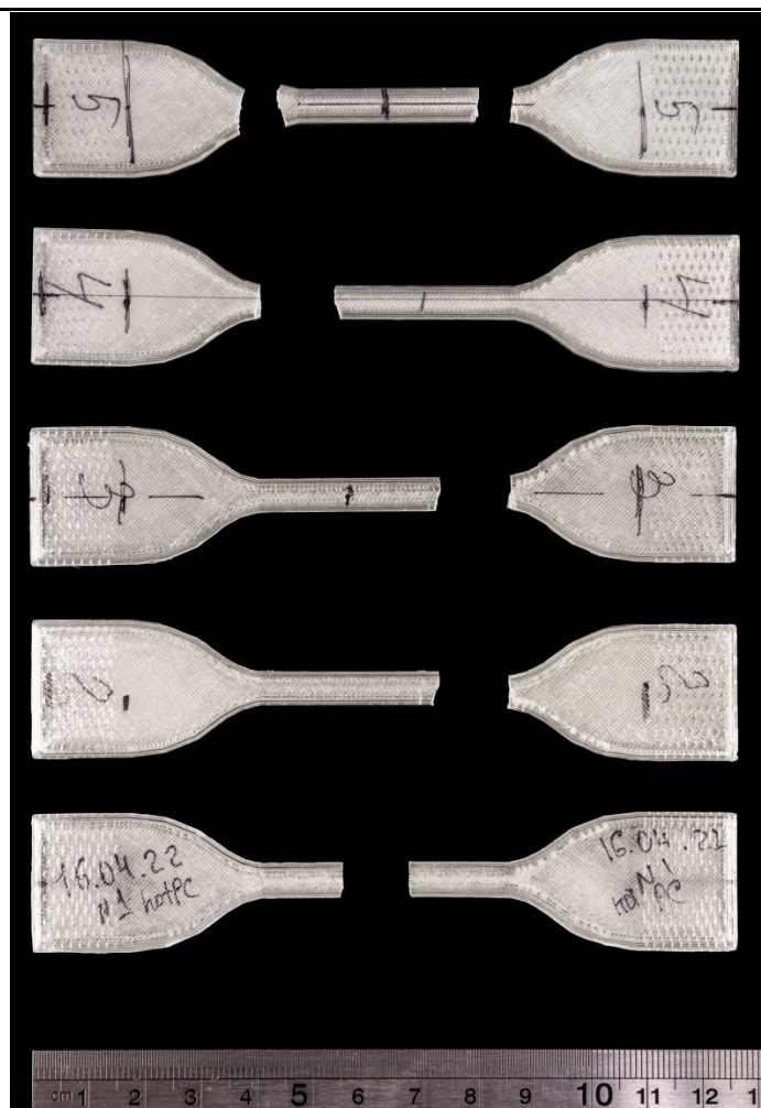
Рис. 2. Образцы из поликарбоната для 3D-печати после разрушения при растяжении
