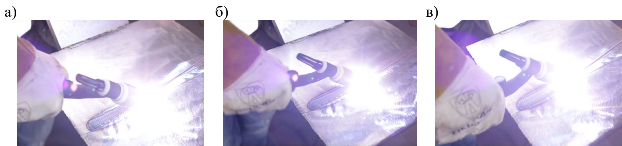
Рис. 2. Манипуляция положением горелки: а – крайнее левое; б – среднее; в – крайнее правое
