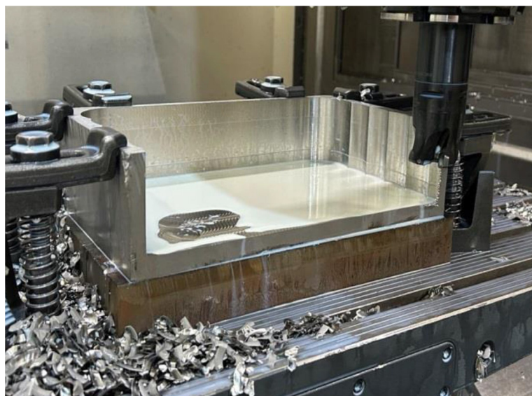
Рис. 2. Рабочая зона станка модели DMU80P dB при фрезеровании фрезой KB15-42C4-Z4 (фреза видна справа сверху)
