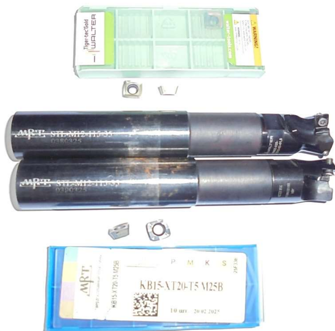
Рис. 1. Фото фрез сборных с двумя зубьями, верхняя фреза фирмы Walter, нижняя – ООО «НПФ Промресурс», марка MRT. Рядом с корпусами фрез на фото показаны их твёрдосплавные режущие пластины
