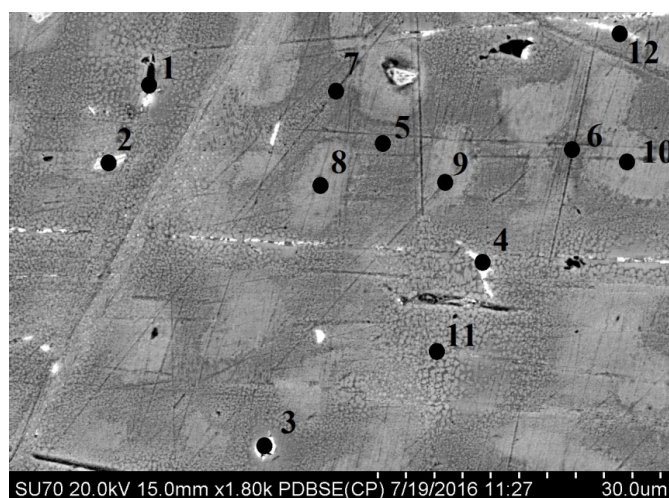
Рис. 2. Точки анализа элементов в структурных составляющих сплава с 0,05 мас. % лигатуры при изотермической выдержке 10 минут, x1500
