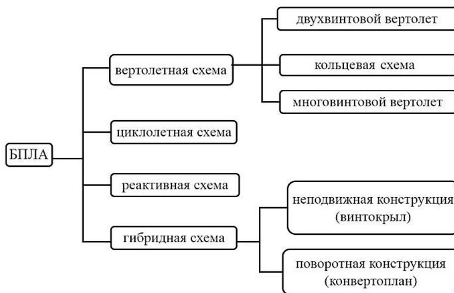
Рис. 1. Классификация БПЛА по аэродинамическим схемам
